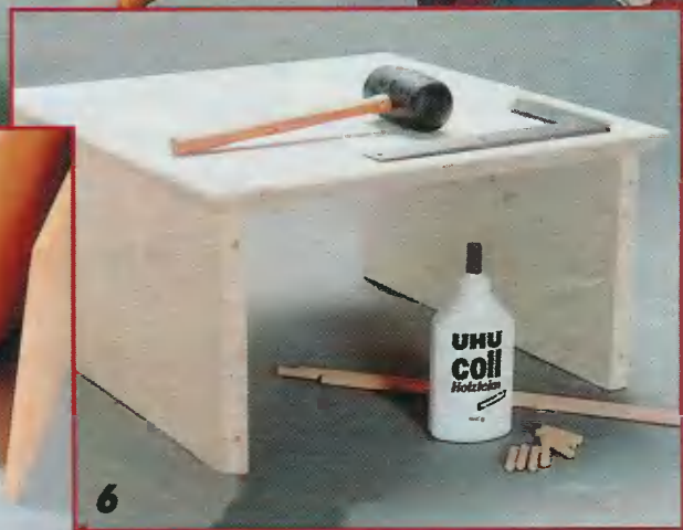
Собрать неразъемный модуль можно с использованием буковых шкантов Ø8 – 10 мм и клея.
