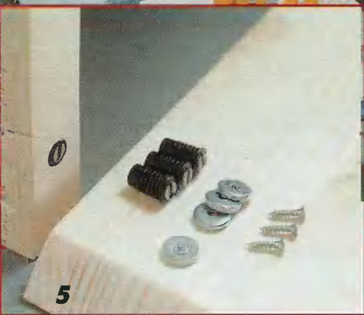
Один из многочисленных типов магнитных защелок. Винты позволяют точно отрегулировать взаимное положение.
