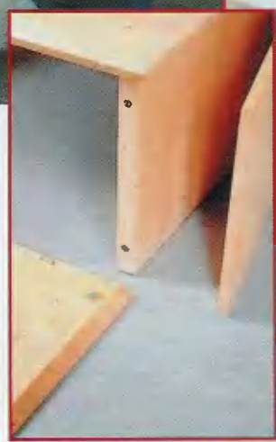
Собрать неразъемный модуль можно с использованием буковых шкантов Ø8 – 10 мм и клея.
